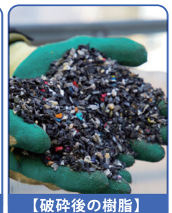
【破碎後の樹脂】
