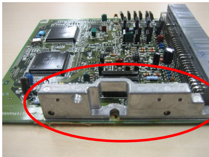
[ 例:アルミ板が付いている基板 ]
