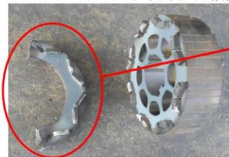
電磁鋼板と磁石を分離するため、バーナーを使用したら、磁石がポロポロになってしまった。
