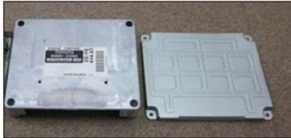
解体工程で取り外した部品（一次分別）からカバーを外して基板を回収する
