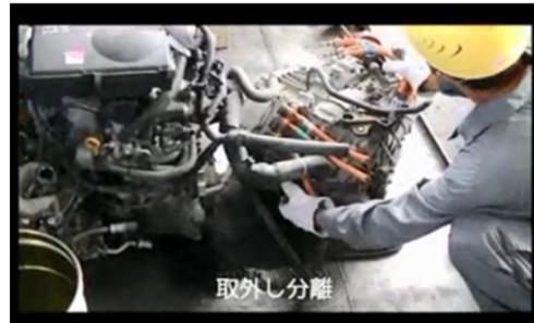
3. トランスミッションAssyから駆動モーターと発電モーターを分離する。
