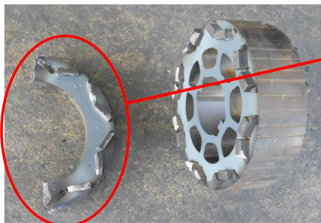
電磁鋼板と磁石を分離するため、バーナーを使用したら、磁石がボロボロになってしまった
