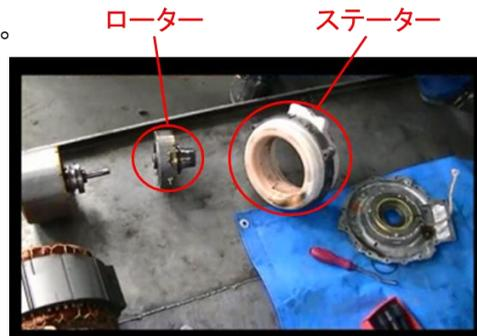
5. 駆動モーターと発電モーターそれぞれのローターを加熱し、消磁を行う。
