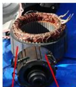
写真③ モーターの 磁石部分 （円周部分がNd磁石）
