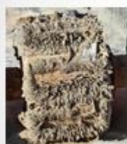
写真① (左) ネオジム磁石への 砂鉄の付着状況
