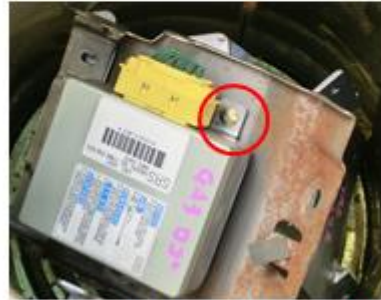
写真② 赤丸部分がリベット接合
