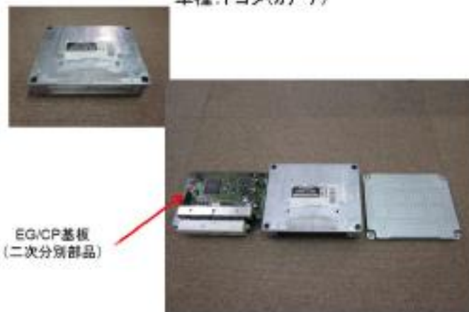
図 3-2 EG/CP の形状と取り出すべき基板の説明
