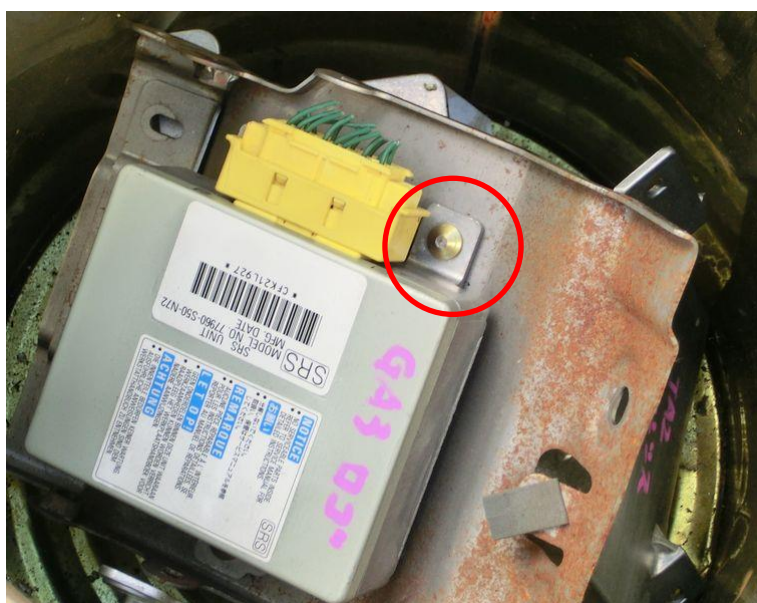
図 3.12 コンピューターのリベット接合事例（赤丸部分）
