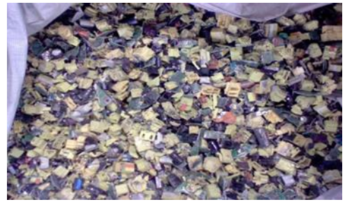
図 3.2 AB/CP 基板破碎後
