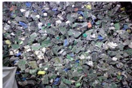
図 3.1 EG/CP 基板破碎後
