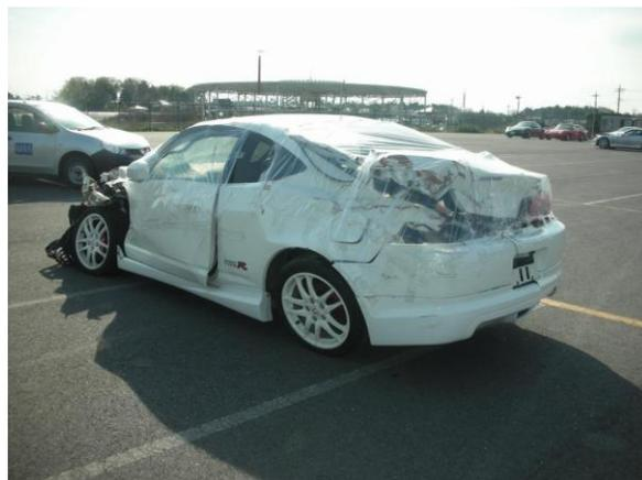
◇車両前方及び後方が激しく損傷し、タイヤも歪んでいる
