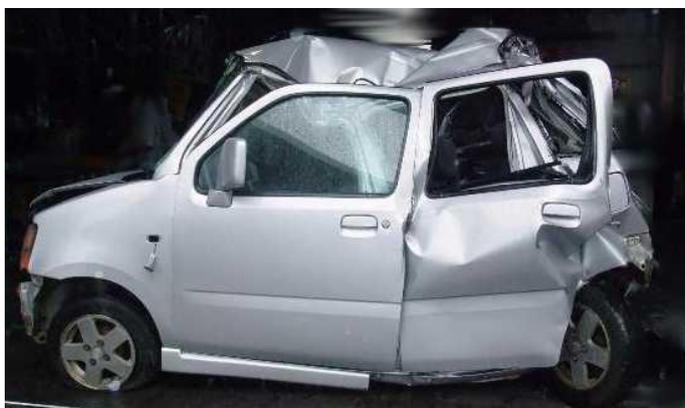
◇車両骨格に重大な損傷があり、修繕に経済的価値が見いだせなかった車両
