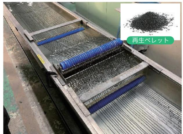
写真：ルーダーマシン (③の造粒において、細長く伸ばし、金太郎飴のように裁断してペレットになります。)
