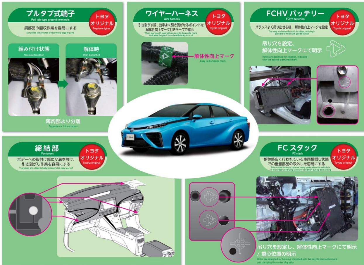
図－1 構造の工夫・易解体設計
