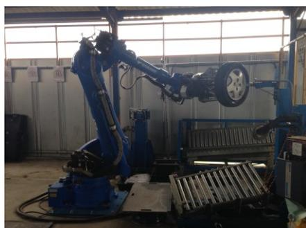
株式会社シーパーツは、自動的にタイヤからホイールを外してタイヤの品質もチェックできるロボット「全自動品質管理機能付きタイヤ脱着システム」を開発しました。これは、安川電機などと協力して制作したもので、重量は1,050キログラムと1,020キログラムの2種類があり、制御盤のタッチパネルで操作します。株式会社シーパーツでは、すでに岩国工場と山口工場を導入しており、このロボットで取り外したタイヤとホイールを販売しています。
