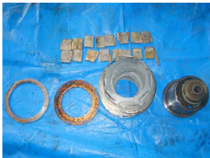
(↑写真:駆動モーターのローターを分解したもの・ネオジム磁石など)
